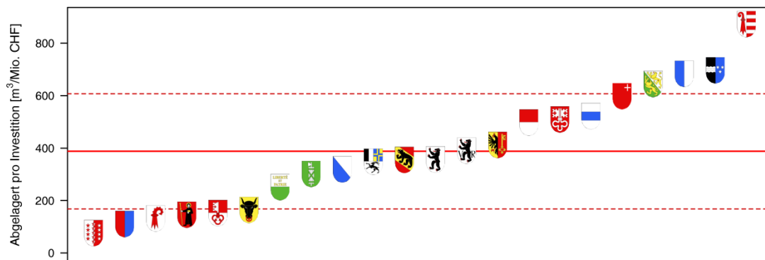
Abbildung 20: Das Verhältnis „Abgelagertes Volumen Aushub pro Franken Bauinvestition“ der einzelnen Kantone, sortiert nach der Grösse. Die rote Linie zeigt den Mittelwert von knapp 400 \text{ m}^3/\text{Mio. CHF} \pm eine Standardabweichung von 220 \text{ m}^3/\text{Mio. CHF} .
